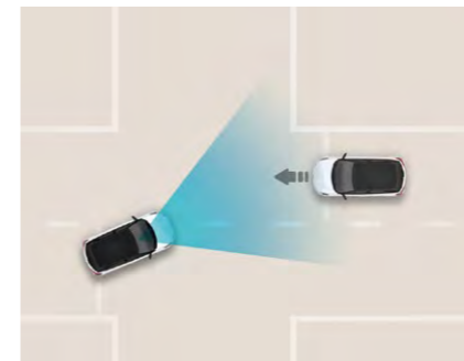
Σύστημα Αυτόματης Έκτακτης Πέδησης (FCA- Junction Turning) κατά τη στροφή σε διασταύρωση
