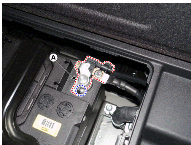
4-3. Γυρίστε τον διακόπτη ανάφλεξης στο OFF και αποσυνδέστε τον αρνητικό (-) ακροδέκτη (A) της βοηθητικής μπαταρίας των 12V.
