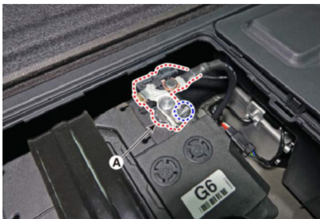
4-3. Γυρίστε τον διακόπτη ανάφλεξης στο OFF και αποσυνδέστε τον αρνητικό (-) ακροδέκτη (A) της βοηθητικής μπαταρίας των 12V.
