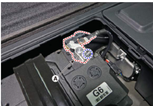
3-3. Γυρίστε τον διακόπτη ανάφλεξης στο OFF και αποσυνδέστε τον αρνητικό (-) ακροδέκτη (A) της βοηθητικής μπαταρίας των 12V.
