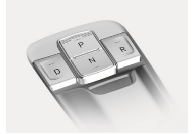
Πιέστε τη θέση στάθμευσης (P)
